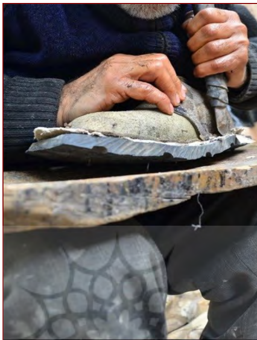
عکس ۸- برش اطراف زیره به وسیله گزدن، و هماهنگ کردن شکل و اندازه آن با کف قالب (www.tasnimnews.com)
