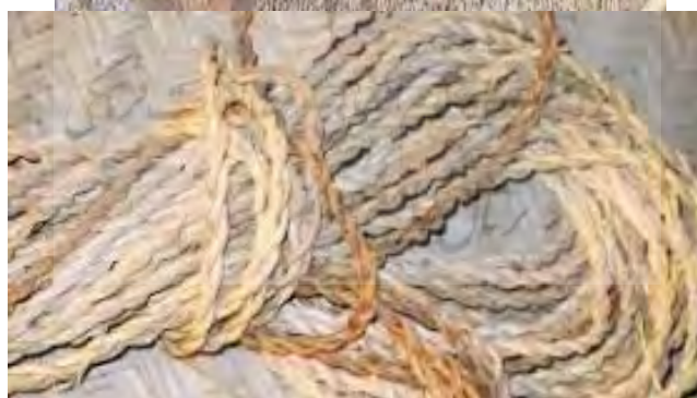
تصویر ۲- چیلک، تهیه شده از برگ نخل یا داز (نخل ایرانی) برای بستن نقاط اتصال
