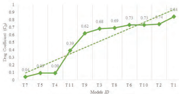
شکل ۵. نمایش تغییر ضریب پسا در نسبت با تغییر در فرم‌های با سطح مقطع مثلث
