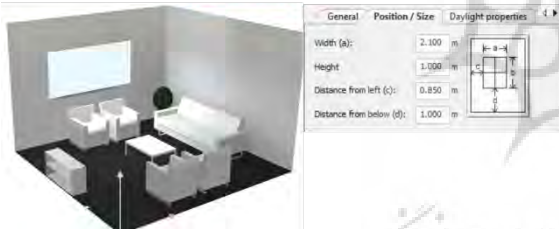
شکل ۱۰. محاسبه ابعاد مناسب پنجره هال و پذیرایی با در نظر گرفتن متوسط نور روز مناسب ( DF=1.5\% ) برای این کاربری. ابعاد پنجره، برابر ۲/۱۰ متر مربع به دست آمده است. این اندازه برابر ۲/۸۴٪ کل سطوح داخلی اتاق و ۲۰٪ چداره نورگیر می‌باشد.
