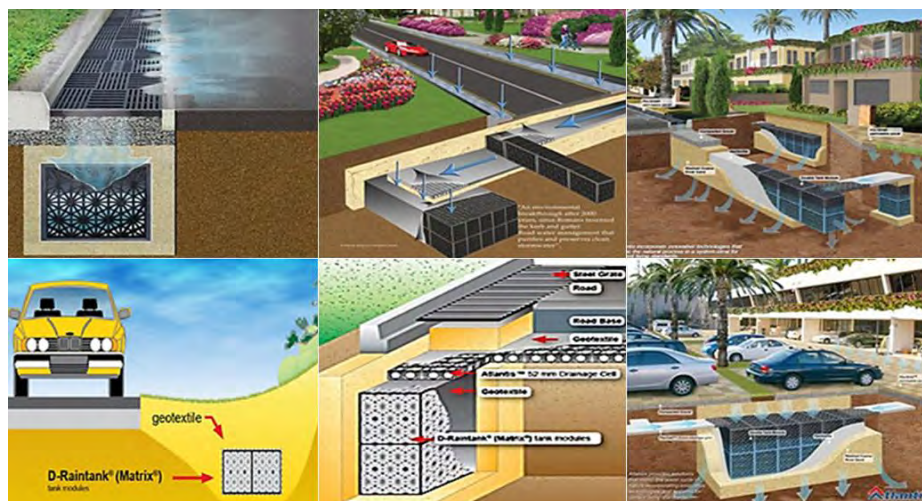
شکل ۱: موقعیت شبکه زهکش مسطح و مخازن CVF؛ مأخذ: بازسازی نگارندگان از شرکت ماناصنعت، ۱۳۹۴
