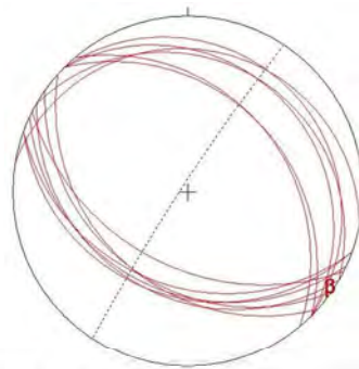
شکل ۹ - نمودار تاقدیس پابده با پلانژ جنوب شرقی محور و یال‌هایی که شیب شمال شرقی و پر شیب جنوب غربی
