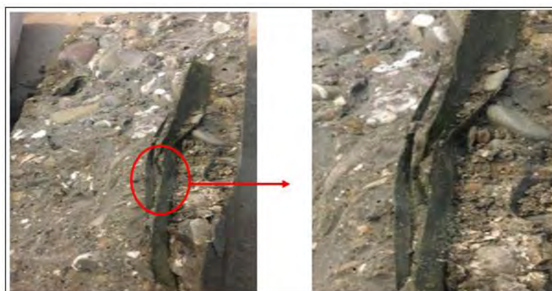
شکل ۵. نمونه بتن استوانه ای پس از وارد کردن فشار و گسیخته شدن برگ های موجود در بتن منبع: یافته های پژوهش، ۱۴۰۰
