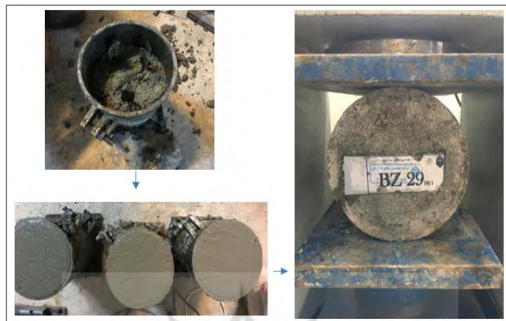
شکل ۳. مراحل ساخت نمونه بتن و تست برزیلی
