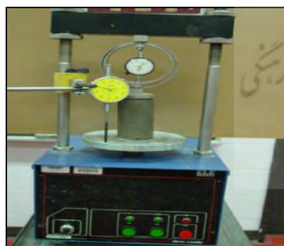
شکل ۱ (پ): آزمایش فشاری تک‌محوری
