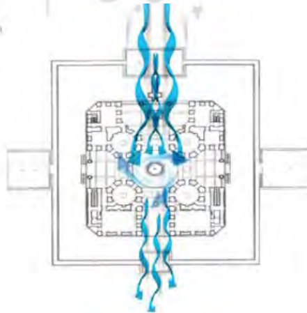
شکل ۴. سامانه تهویه طبیعی و برودت تبخیری در کوشک هشت بهشت (مأخذ: قیومی بیدهندی، ۱۳۸۳)
