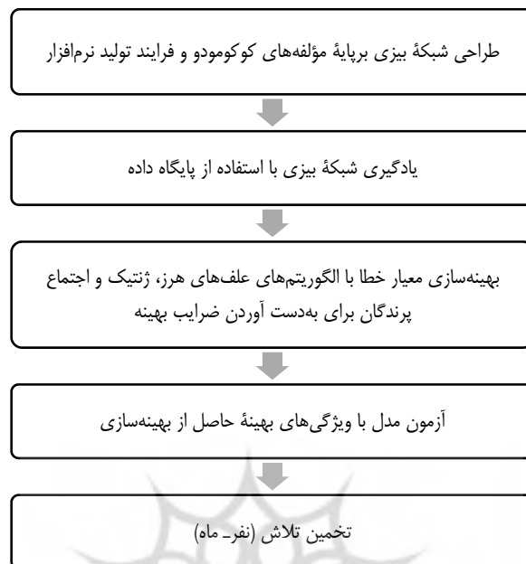
شکل ۱. مدل پیشنهادی برای تخمین تلاش مورد نیاز برای تولید نرم‌افزار
