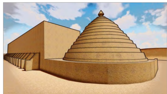
تصویر ۱. تصویر شماتیک گنبد و دیوار سایه‌انداز یخچال عباس‌آباد رفسنجان (نگارندگان)
