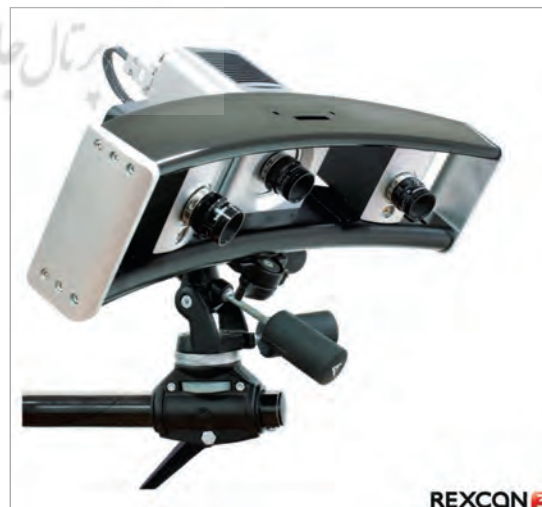
تصویر ۶. اسکنر لیزری رکس کن سه؛ مورد استفاده در اسکن نمودن نمونه مورد مطالعه این تحقیق (پژوهشگران صنعت آریا، ۱۳۹۴)
