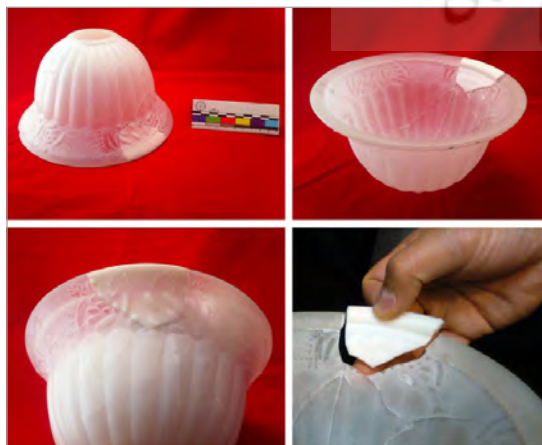
تصویر ۱۲. اثر شیشه‌ای مورد مطالعه بعد از اتصال قطعه بازسازی‌شده به وسیله تکنولوژی‌های مدل‌سازی سریع (نگارندگان)
