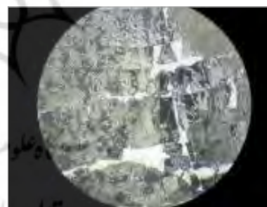
تصویر ۱۴. پوسته‌پوسته‌شدن مرکب از روی تکیه‌گاه، نمونه S_1 ، با بزرگ‌نمایی ۳۰ برابر (نگارندگان)
