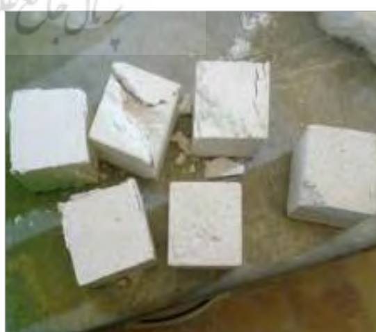
تصویر ۲۵. نمونه‌های باز تولید شده بعد از آزمایش مقاومت فشاری (نگارندگان)
