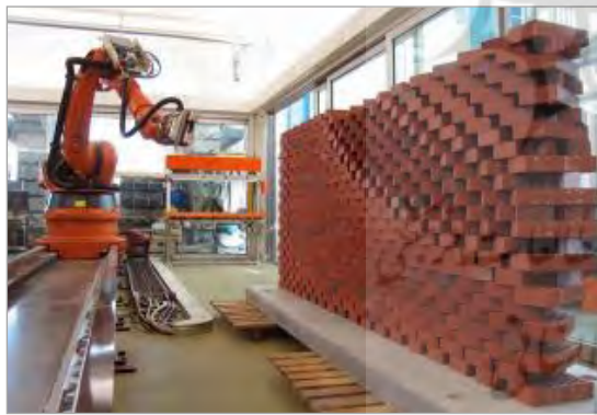
تصویر ۲. دیجیتال چینی دیوار آجری به وسیله ربات ۶ محوره در دانشگاه ETH (روش افزایشی)، (robotspodcast.com)
