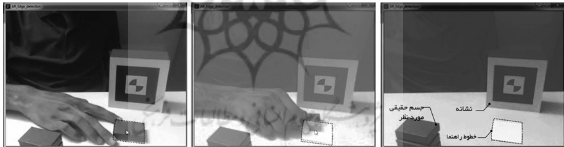
تصویر ۸. نحوه قرارگیری جسم حقیقی در مکان مقرر به کمک خطوط به نمایش درآمده در صفحه نمایشگر (الف: شروع فرایند (ب: مکان‌یابی جسم حقیقی (مواد ساختمانی) در مکان مشخص شده به کمک خطوط راهنما (ج: قرار گرفتن جسم حقیقی (مواد ساختمانی) در وضعیت نهایی (نگارندگان)
