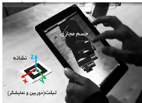
تصویر ۵. وسایل استفاده‌شده برای واقعیت افزوده؛ مشاهده تصویر مجازی براساس نشانه در نمایشگر (www.shelf3d.com)
