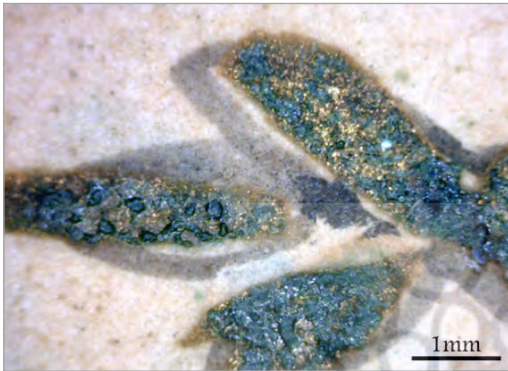
تصویر ۴. سبزشدگی تزیینات طلائی از سطح زیرین رنگدانه‌ها، نسخه قرآن (نگارندگان).
