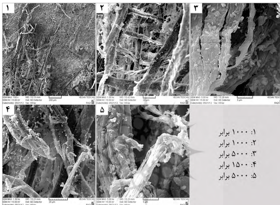
تصویر ۷. عکس‌های SEM از تأثیر قارچ سفالوسپوریوم در نمونه کتاب قانون: ۱. تأثیر قارچ بر یکپارچگی الیاف ۲. فضای بین الیاف کاغذ در نقطه قارچ‌زده ۳. جدایش بین الیاف کاغذ در نقطه قارچ‌زده ۴. جدایش بین الیاف کاغذ در نقطه قارچ‌زده ۵. شکست و تخریب الیاف کاغذ در نقطه قارچ‌زده (نگارندگان).
