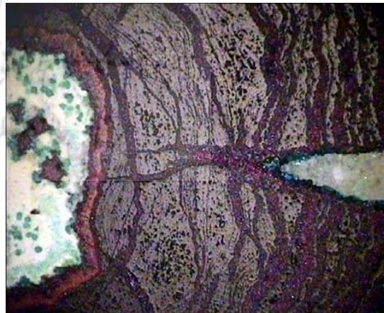
تصویر ۶. ریزساختار نمونه HT-41. ساختار لایه لایه در فاز کوپریت به خوبی قابل دیدن است. بزرگنمایی ۵۰ برابر.
