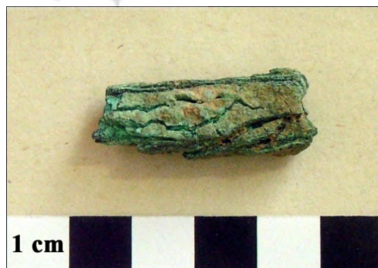
تصویر ۱. یکی از نمونه‌های برنزی مورد مطالعه. شیء کاملاً به محصولات خوردگی تبدیل شده و ترک خورده است.
