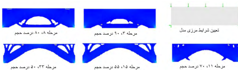
شکل ۲) توزیع مصالح در چرخه‌های بهینه‌سازی توپولوژی در یک پل
