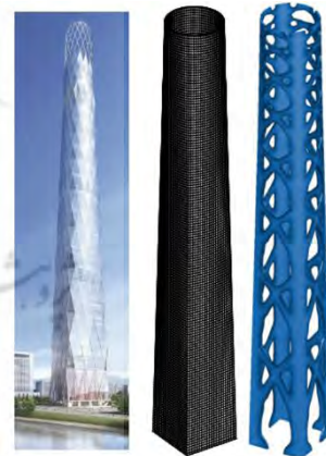
شکل ۵) نمای دیاگرید فرم یابی شده به وسیله بهینه سازی توپولوژی [۱۳]
