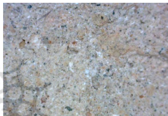
شکل ۱۳: تصویر مقطع عرضی ساختار گچ در تزئینات تخمه‌درآوری مسجد کبودانی با میکروسکوپ نوری با بزرگنمایی 10X Fig. 13: Cross-section image of the gypsum structure in the tokhmeh daravari decoration of Kabodani mosque with light microscope 10 X
