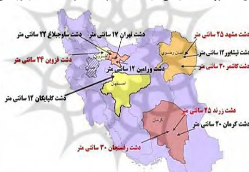
شکل ۴: فرونشست زمین در نتیجه تخریب سفره‌های آب زیرزمینی
