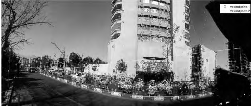
شکل ۱۵: نتیجه شدت متفاوت در عکس‌ها برای الگوریتم surf
