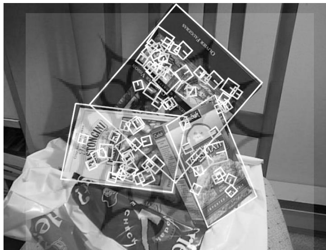
شکل ۲: نقاط کلیدی به دست آمده به وسیله SIFT؛ Lowe, 2004
