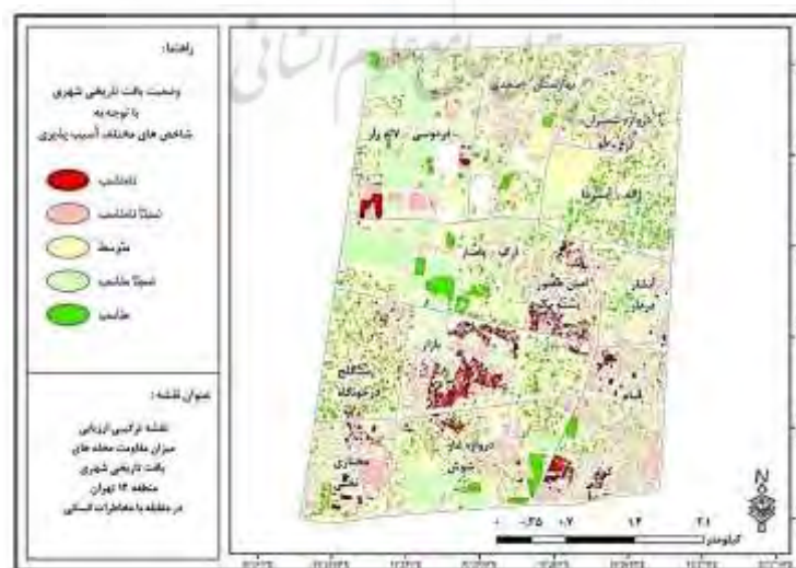
شکل ۱۱. ارزیابی میزان مقاومت بافت تاریخی شهری منطقه ۱۲ تهران در برابر مخاطرات انسانی
