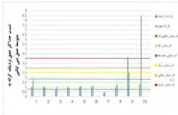
شکل ۱۹. نمودار نسبت حداکثر عمق نزدیک کرانه به متوسط عمق دبی لبالی (نویسندگان، ۱۳۹۷)
