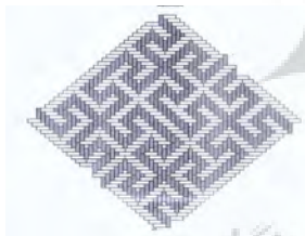
شکل ۱۶: جزییات آجرکاری تزئینی در طاق‌نماهای ضلع شرقی بنا (نوربخش و صفدریان، ۱۳۸۲: ۷۲).
