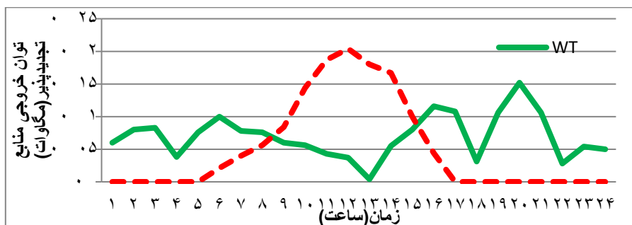
شکل ۴. توان خروجی توربین‌های بادی و پنل‌های فتوولتائیک هاب (وو) و همکاران، ۲۰۱۷ با تغییر"
