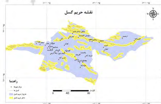
شکل (۱۰) نقشه نهایی پهنه بندی خطر زلزله به دو پهنه درون و بیرون از حریم گسل.
