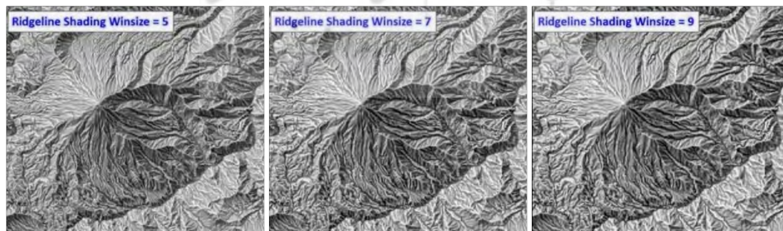
شکل ۲۸: استفاده از سایه خط‌الرأس و خط‌القعر در نمایش سطح زمین (ابعاد پنجره متحرک ۵، ۷، ۹)
