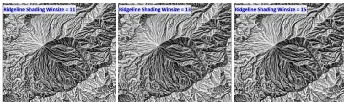
شکل ۲۹: استفاده از سایه خط‌الرأس و خط‌القعر در نمایش سطح زمین (ابعاد پنجره متحرک (۱۱، ۱۳، ۱۵)
