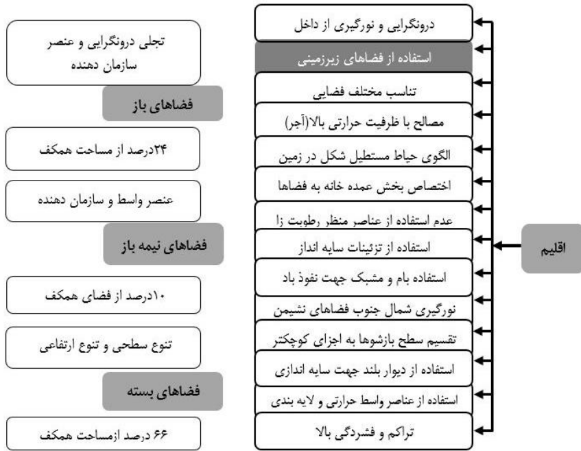
نمودار ۴- تحلیل مهم ترین الگوهای اقلیمی در خانه سنتی دزفول (منبع: مهدوی نژاد و همکاران، ۱۳۹۲: ۷۱)
