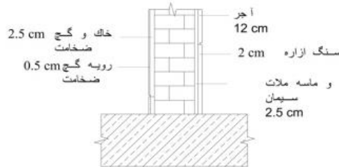
تصویر ۲- جزئیات اجرای دیوارهای مدرسه (http://www.liveroof.com/detail-drawings)
