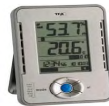
تصویر ۲- دستگاه data logger TA 120 (www.supertransensing.com)
