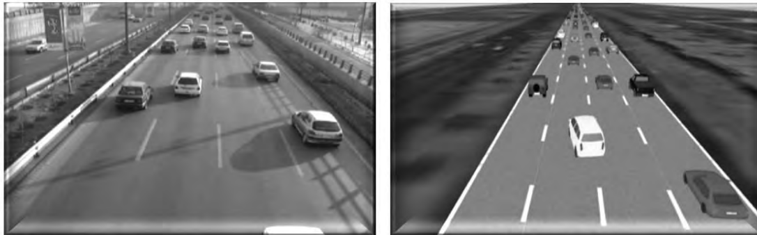
شکل ۳: چپ: تصویر برداشت شده دوربین نصب شده در ایستگاه ۱ و راست: دوربین مجاز نصب شده در مدل ساخته شده برای بزرگراه پس از کالیبره کردن مدل.
