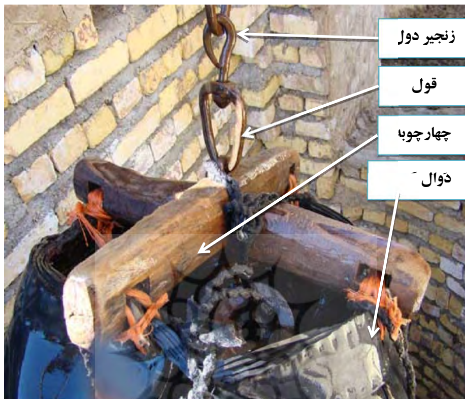
عکس ۹- اجزا و عناصر تشکیل‌دهنده دلو در گاوپناه حاج ابراهیم (ورزنه)
