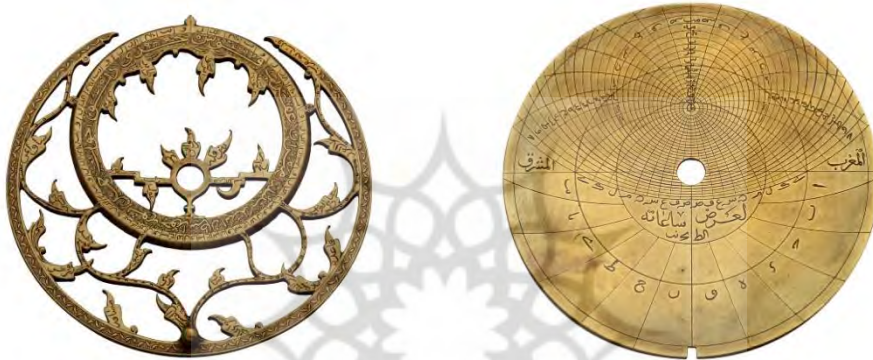
شکل ۲. صفيحه (راست) و عنکبوت (چپ) اسطرلاب معیار (ساخت عبدالأمنه، قرن ۱۲ق، اصفهان)؛ www.adlerplanetarium.org/collections/
