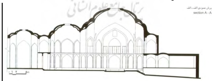
شکل ۵: برش سه گنبد تیمچه امین‌الدوله (گنج‌نامه، ص ۶۹)
