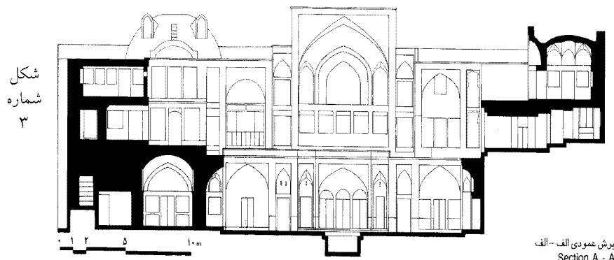
شکل شماره (۳) برش عمودی نقشه خانه عباسیان که از امتداد طولی خانه برداشت شده است. طبقه زیرین که به صورت گودال باغچه از سطح عمومی کوچه پایین تر است کاملاً در تصویر مشخص است (منبع: گنجنامه ۱۳۷۵: ۱۲۶).
