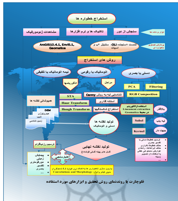
شکل (۲).فلوچارت یا روند نمای روش تحقیق و ابزارهای مورد استفاده
