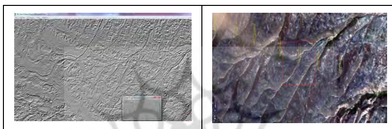
شکل (۵) راست تصویر لندست ۸ و چپ فیلتر جهت‌دار با کرنل 3 \times 3 با زاویه عمود بر سمت تابش از همان منطقه
