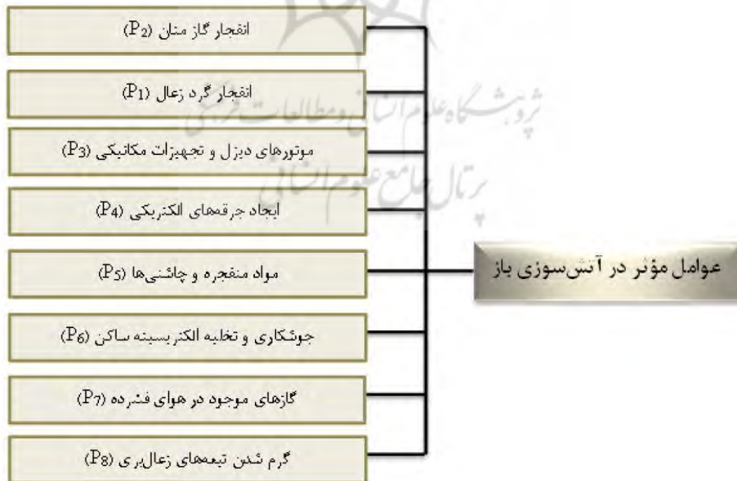
شکل ۲: عوامل مؤثر بر حریق در سیستم طبقه بندی پیشنهادی در معادن زغال سنگ
