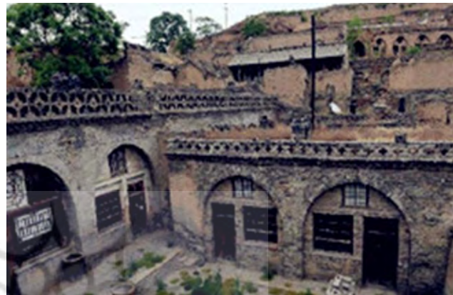
تصویر ۸- خانه گودال باغچه ای در منطقه شیجاگو، چین. اتاقها در بستر زمین و در چهار طرف گودال باغچه حفر شده اند و با آجر نماسازی گشته اند. (مأخذ: Knapp, Ronald G, 1989)
