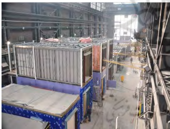
تصویر ۵: ساخت واحدهای برج کارمل پلیس در کارگاه منبع: (Mears&Ruth.2019)
