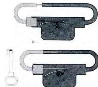
تصویر ۱۴: مکانیزم درونی فنر خاردار (تناولی، ۱۳۸۶، ۲۹).
