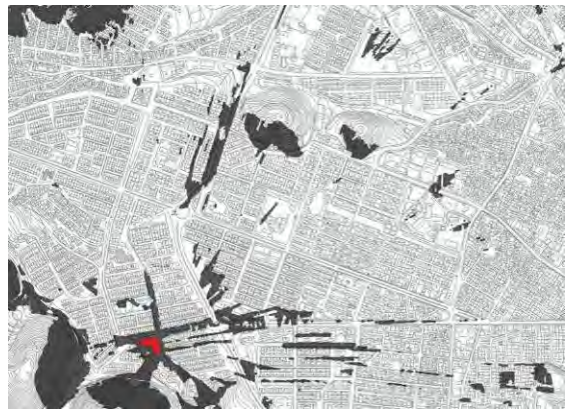
تصویر شماره ۱۱: رویت پذیری طبقه هشتم ساختمان شماره ۲
