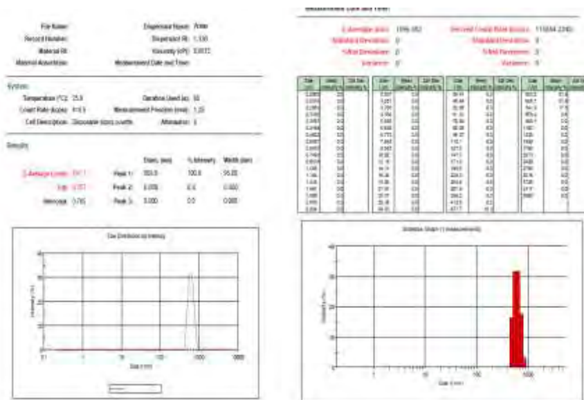
شکل ۱۱. طیف خروجی از زتاسایزر جهت بررسی ذرات
