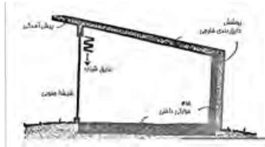
شکل ۱: مقطع شماتیک از ساختمان خورشیدی ایستا با سیستم جذب مستقیم (منبع: مور، ۱۳۸۲).
