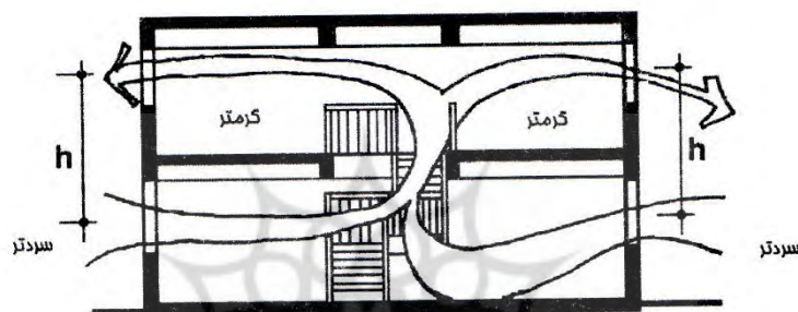
شکل ۳: تاثیر دودکشی راه پله در یک ساختمان دوطبقه (Givoni, 1998).
