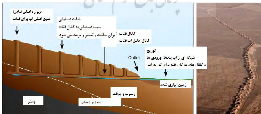
شکل ۶. سمت چپ) شیوه حفر چاه ها و (سمت راست) طراحی ردیفی چاه
