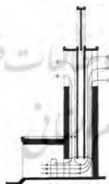
شکل ۱۴: راست: بادگیر کاروانسرای ابوالقاسم رشتی عقدا (مأخذ: نگارندگان) / چپ: طرحی از نحوه عملکرد بادگیر کاروانسرای ابوالقاسم رشتی عقدا (مأخذ: توسلی، ۱۳۸۱: ۹۳)
