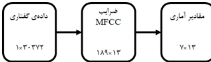
شکل ۵. روند کاهش اندازه بردار ویژگی برای ۱۳ ضریب نخست MFCC
