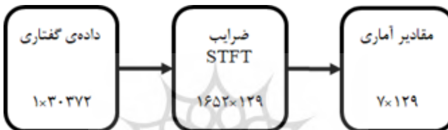
شکل ۶. روند کاهش اندازه بردار ویژگی برای مقادیر STFT
