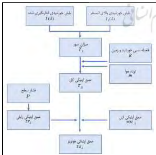
شکل ۸- طرح‌واره فرآیند محاسبه عمق اپتیکی هواویز
