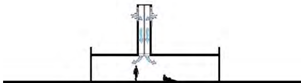
شکل ۷) برش ارتفاعی بادگیر مدل شده در فرآیند آزمایش
